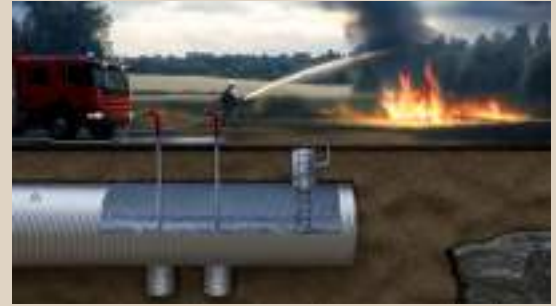
Cuve incendie enterrée - Image d'illustration DR Via Con
